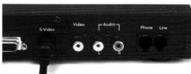
Obrázek 3 - 8 „Připojení S - Video kabelu“
